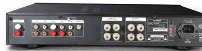
▲ Der Vollverstärker liefert ordentlich Saft und ist mit Phono, Bluetooth, Kopfhörerbuchse und zwei Paar Lautsprecheranschlüssen besser ausgestattet als mancher Bolide.
